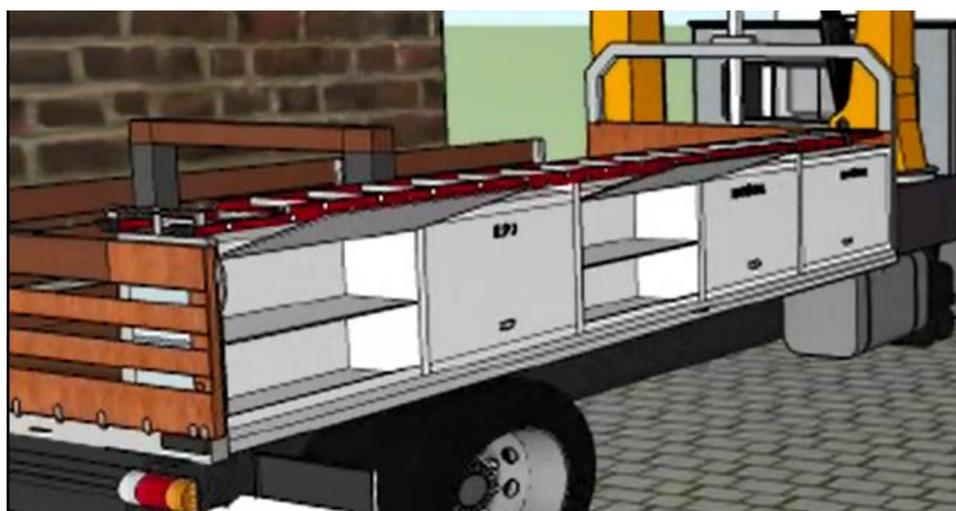
O mesmo deverá possuir 5 divisões conforme demonstrado na visão geral acima, e na parte posterior do mesmo, no fim da carroceria, deverá possuir um espaço com furação de diâmetro de 700mm para acondicionamento de brocas
